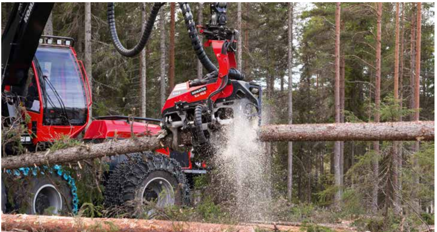
Eine fettgeschmierte Kette, ECO-GLS, mindert Umweltauswirkungen. Optional verfügbar für Komatsu C93, C123, C124 und C144.
