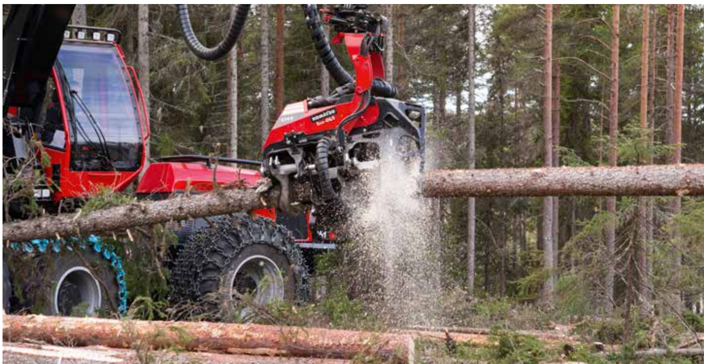
Rasvavoideltu Eco-GLS-ketju vähentää ympäristövaikutuksia. Saatavana lisävarusteena Komatsu-malleihin C93, C123, C124 ja C144.
