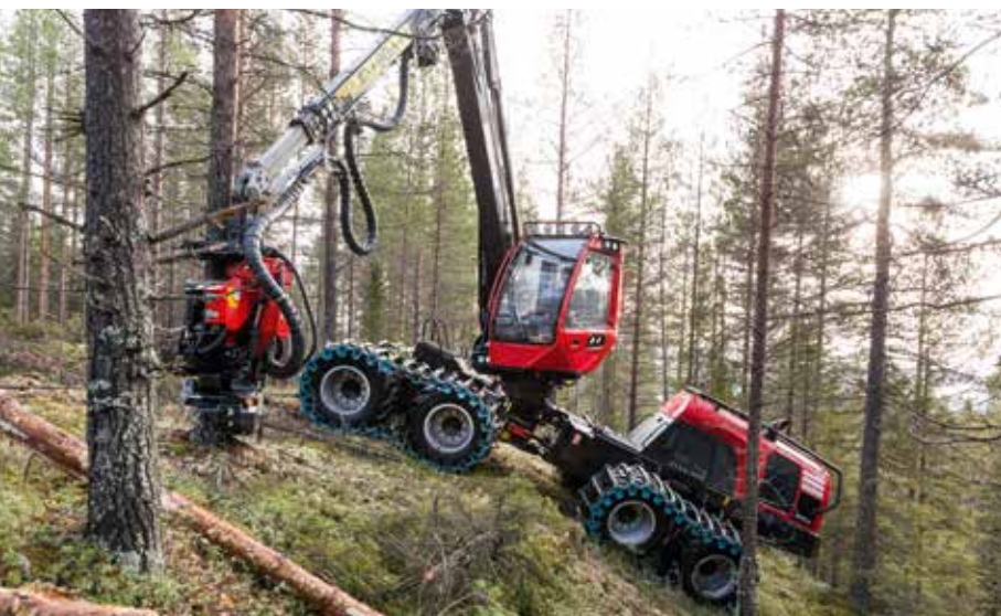
Komatsun hakkuukoneet ovat hyvin vakaita, ja niiden pintapaine on pieni.
