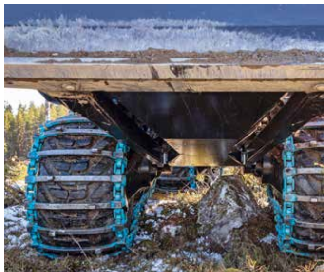
Portaalitelin ansiosta sekä kuormatraktoreiden että hakkuukoneiden maavara on paras mahdollinen.
