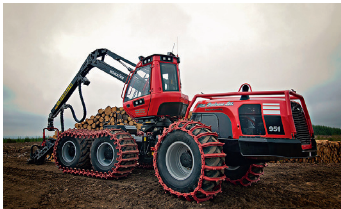
La nueva máquina fue provista de tracks en el bogie y en cada rueda individual.
